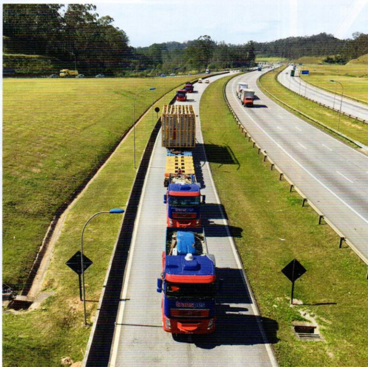
Três cavalos mecânicos 6x4 carregaram um transformador entre Guarulhos e Santos
